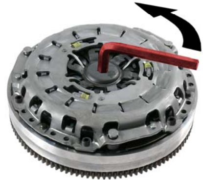
Fig. 3: Verriegelungsstück herausdrehen / Unscrew locking piece / Retirer la pièce de verrouillage en tournant / Desenroscar la pieza de enclavamiento / Rimozione dell'elemento di bloccaggio
