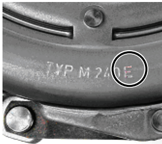
Kuva 2: Kaikissa Xtend-kytkimissä on lisämerkintänä kirjain E. Esimerkki: M 240 E
