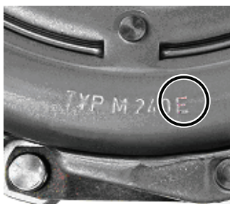
2. ábra: Minden Xtend kuplung "E" kiegészítő betűjelzéssel van ellátva. Példa: M 240 E
