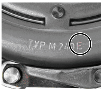
Obr. 2: Všechny spojky Xtend jsou označeny navíc písmenem E. Příklad: M 240 E
