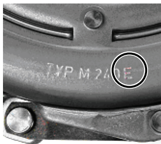
Fig. 2: Alle Xtend Kupplungen tragen den Zusatz-Kennbuchstaben E. Beispiel: M 240 E
