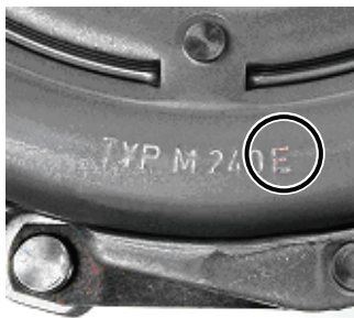
Fig. 2: Todas as embraiagens Xtend têm a letra de referência adicional E. Exemplo: M 240 E
